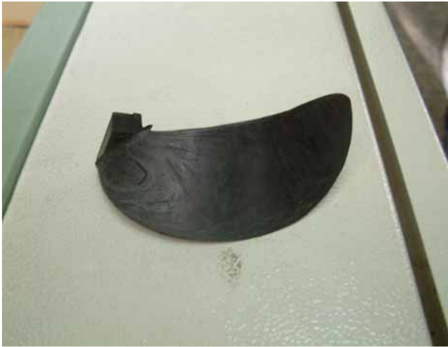
圖 4-9. 修整邊緣後的葉片
