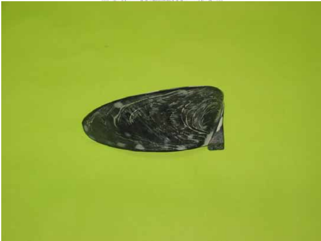
圖 4-10. 加工製作完成之螺槳葉片
