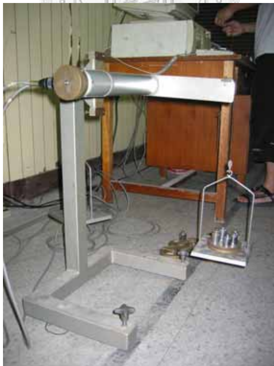
圖 4-14. 進行動力儀扭力校正
