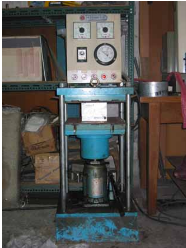
圖 4-7. 葉片於熱壓機中熱壓成形
