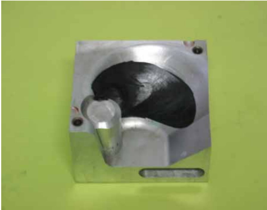
圖 4-5. 在 DTNSRDC-4498 的模具上積層
