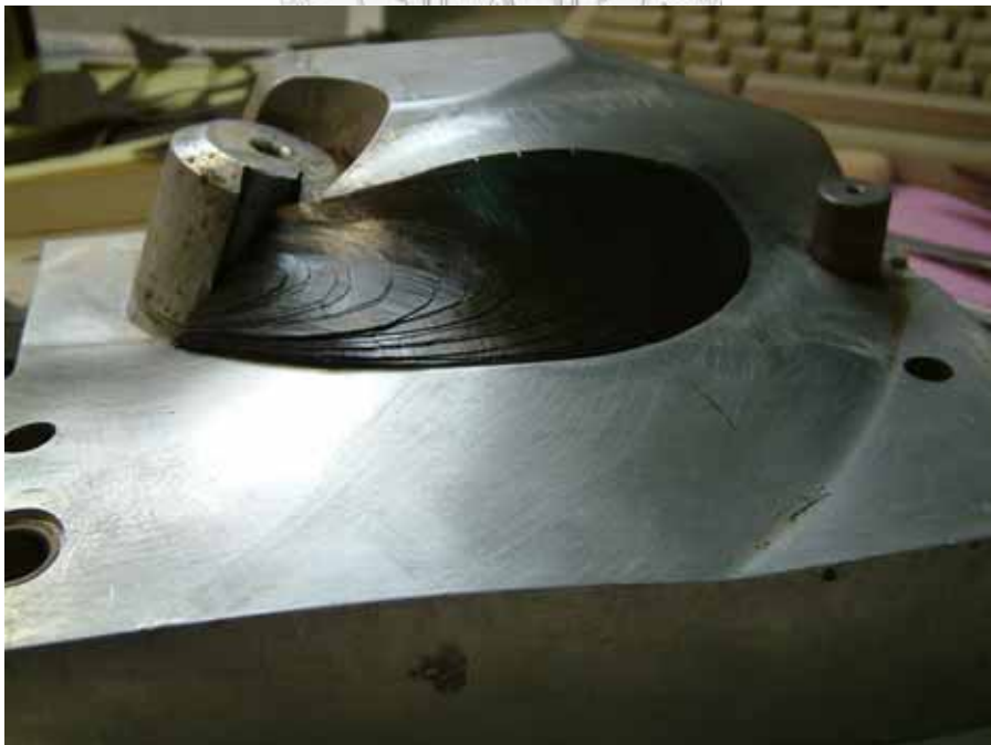
圖 4-6. 在 DTNSRDC-4383 的模具上積層
