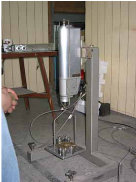
圖 4-13. 進行動力儀推力校正
